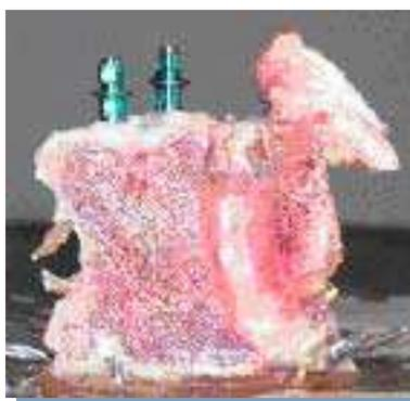
FIGURA 3. Vértebra de cerdo con un implante de cada diseño instalado.
